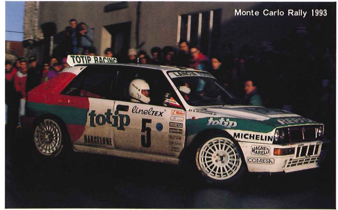
93年、通称“エヴォルツィオーネII”に進化、黄色ずくめの“ジアーラ”も追加。 7.5Jリムに205/45ZR16。エンジンも215psに強化。
