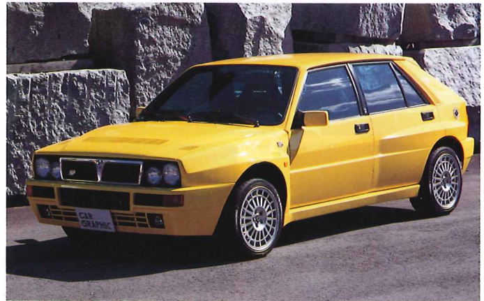
93年、通称“エヴォルツィオーネII”に進化、黄色ずくめの“ジアーラ”も追加。 7.5Jリムに205/45ZR16。エンジンも215psに強化。
