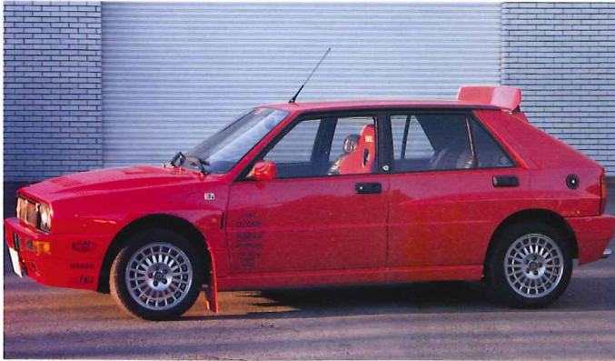
93年、通称“エヴォルツィオーネII”に進化、黄色ずくめの“ジアーラ”も追加。 7.5Jリムに205/45ZR16。エンジンも215psに強化。
