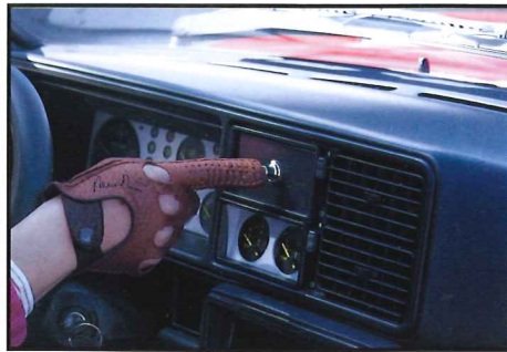
わざわざキーから独立したスターター・スイッチ。でも、この位置は少しわざとらしい。コンソールあたりに付けて「知る人ぞ知る」式で押したほうがスマートかもしれない。
