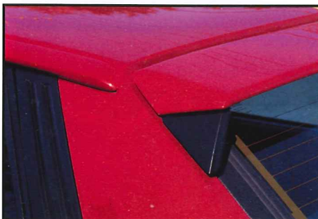
ベンチレーター・アウトレット、スポイラー・ステー、リアウィンドーの周囲など、すべてブラックアウト。
